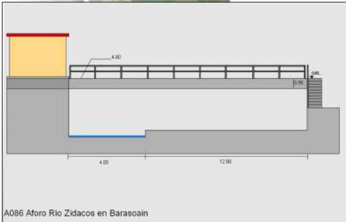
Ilustración 13. Vista y esquema de la estación de aforo de la CHE en el río Zidacos en Barasoain (A086).
