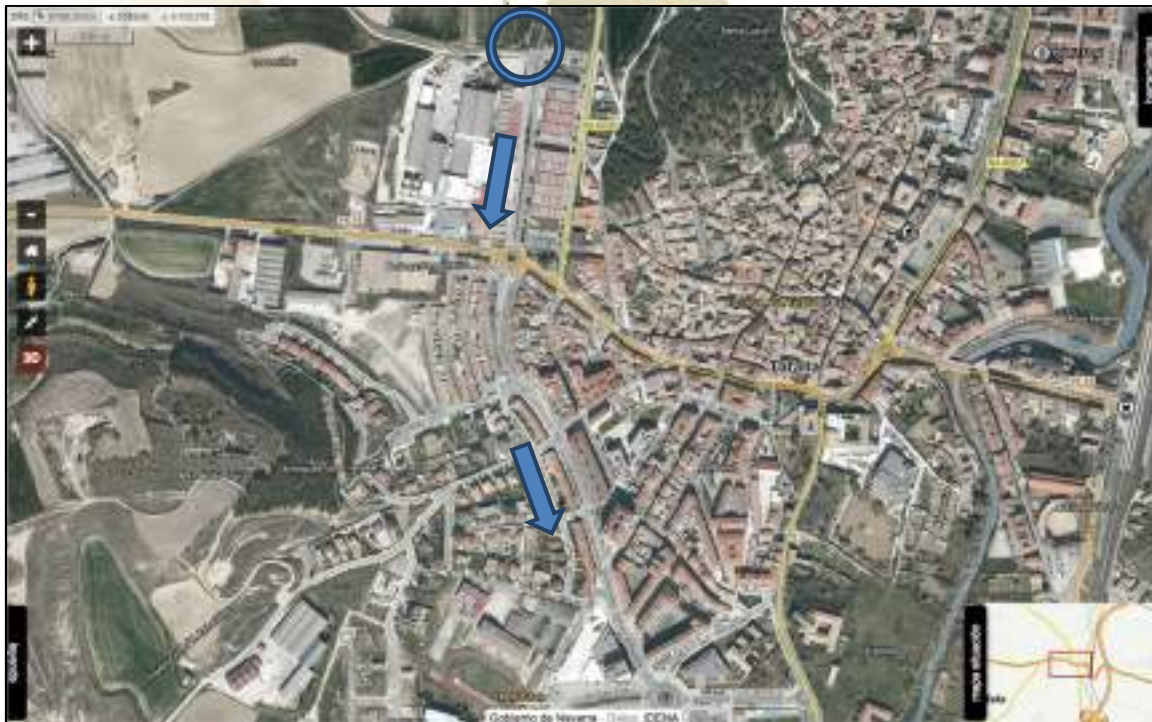
Ilustración 4. Mapa de detalle del trazado del Barranco del Ábaco por el casco urbano de Tafalla. El círculo indica el punto en el que el barranco llega al polígono industrial Abaco, y es canalizado de forma subterránea. Las flechas indican el trazado por la zona urbana de esta canalización enterrada.
